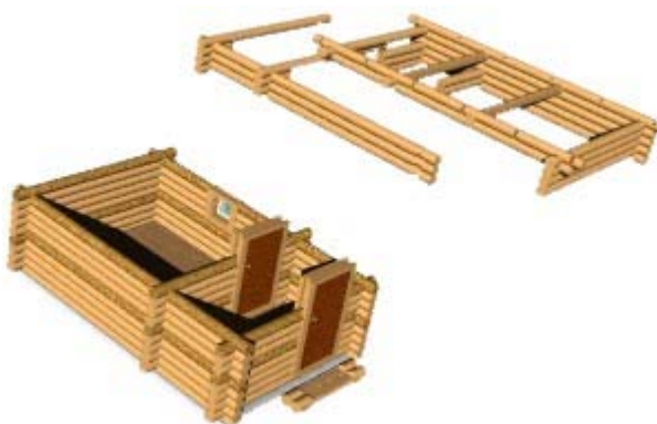
г) Добавлен ряд бревен на уровне окна (выделены цветом), предварительно верхняя часть бревен смещена в сторону
