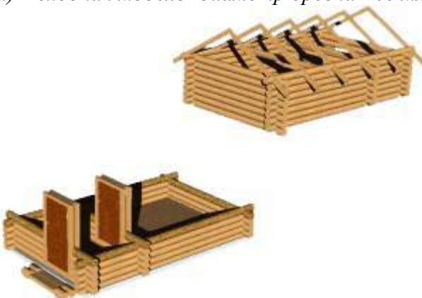
в) Добавлен ряд бревен ниже окна (выделены цветом), предварительно верхняя часть бревен смещена в сторону
