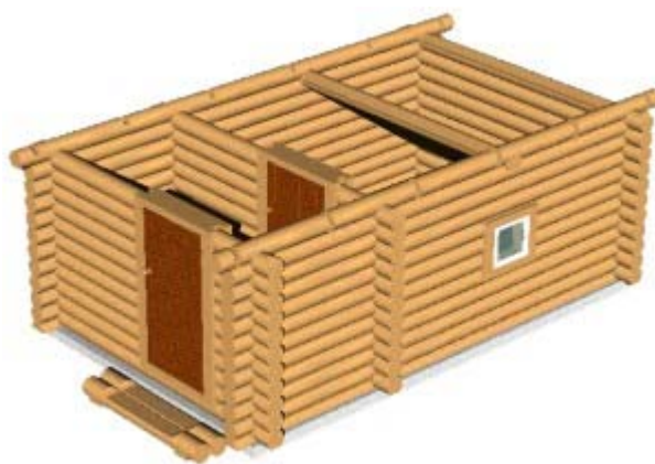
б) Диаметр бревна изменен на 200 мм
